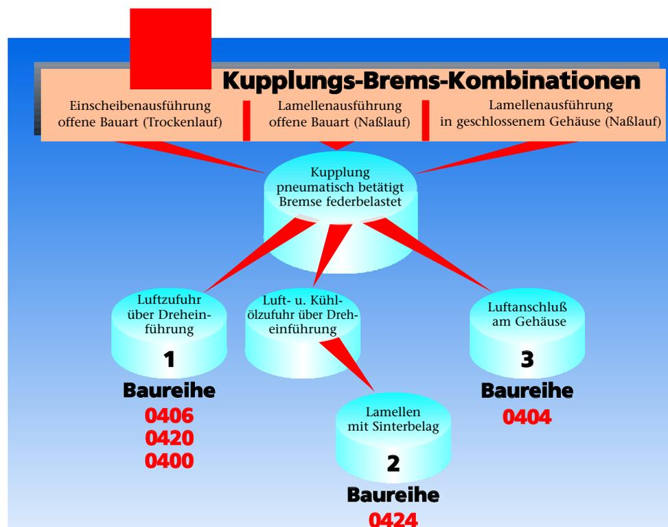
Die Einheiten werden in verschiedenen Gehäusevarianten angeboten, wie z. B. mit Montagefüßen und Wellenzapfen oder mit Hohlwellen und Befestigungsflanschen, wobei beliebige Kombinationen der Anschlußsituation wählbar sind. Eine bedeutende Steigerung der Schaltleistung kann durch zwei Maßnahmen erreicht werden: zum einen durch außen aufgesetzte Elektrolüfter, zum anderen mittels einer Ölumlaufschmierung durch das Gehäuse.
